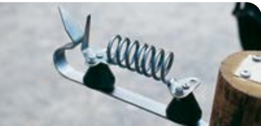
Eine Blitzschutzdrossel bremst schnelle Spannungsanstiege durch den Einschlag eines Blitzes in den Weidezaun. (Bild: BUL)
